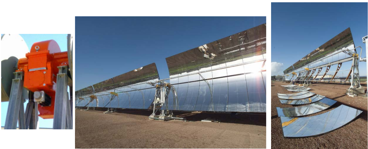
Figura 4 - Assieme del collettore parabolico lineare (al centro), a lato il sistema di movimentazione e gli specchi con la struttura
