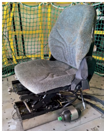
Figura 23 Prototipo di sedile a controllo attivo Inail
