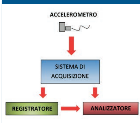
Figura 42 Schema generale di una catena di misura per vibrazioni
