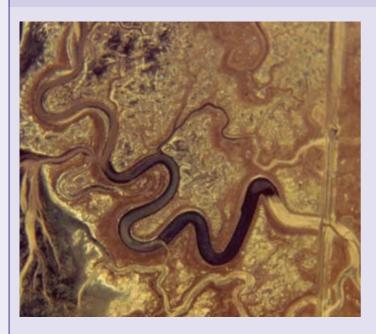
L'ingressione e la regressione dei flussi di marea produce delle correnti la cui idrodinamica è regolata dalla tortuosità e dalla sezione dei canali lagunari.
