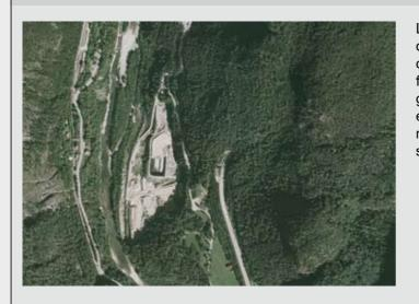
La scarpata di una discarica formata da materiali sciolti o a bassa coesione è facilmente soggetta a franamenti; un provvedimento in grado di prevenirli è il drenaggio e la canalizzazione delle acque meteoriche emergenti al piede della scarpata. The escarp of a dump formed with unconsolidated materials is easily affected by sliding phenomena; a measure able to prevent them is the drainage and the canalization of the water emerging at the escarpment foot.
