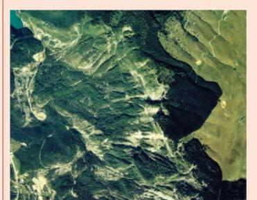
Su scarpate ripide, come questa in località Sitran in comune di Pieve d'Alpago, rocce arenacee molto fratturate e alterate possono produrre distacchi localizzati improvvisi.
