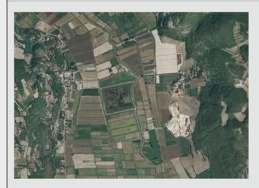
In quest'area pianeggiante dello Scolo Liona (Colli Berici), a monte degli abitati di Sossano e di Orgiano, è stata realizzata una vasca in grado di ricevere l'eccesso di portata del corso d'acqua in concomitanza con eventi metereologici a carattere eccezionale.
