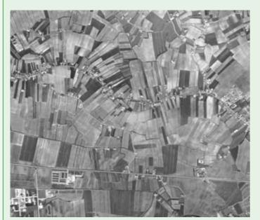
Il costipamento differenziale dei materiali sabbiosi dei grandi alvei fluviali rispetto a quello dei terreni argillosi delle aree di divagazione alluvionale latistanti si riflette sul microrilievo con una fascia leggermente sopraelevata sul piano di campagna generale riconoscibile anche per la tessitura grossolana dei depositi.
