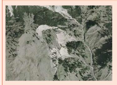
Il distacco di un settore di versante nel processo franoso di "scoscendimento in blocco" determina locali inversioni di pendenza del terreno. Il conseguente cattivo drenaggio può portare alla formazione di ristagni o di piccoli laghetti che aggravano le condizioni di stabilità del rilievo.
