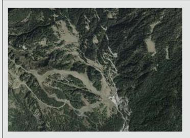
Lo spianamento del rilievo per la realizzazione di piste da sci richiede interventi accurati di manutenzione come la raccolta e la deviazione delle acque di ruscellamento per evitare o rendere minimi i processi di erosione laminare, a rigagnoli o incanalata.
