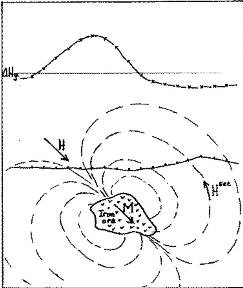
Un oggetto (in questo caso un deposito di minerali ferrosi) è stato magnetizzato con una magnetizzazione  $M$  nella direzione del campo magnetico terrestre  $H$ .
