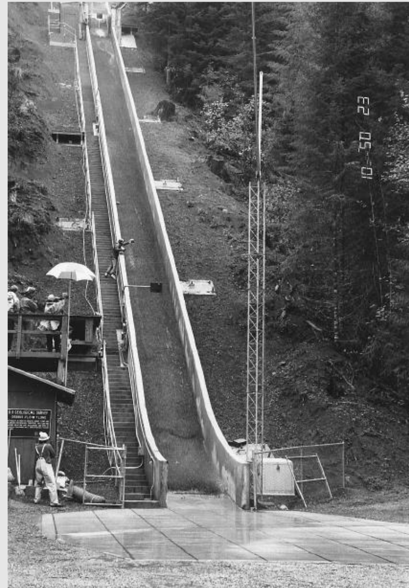
Canale artificiale dell'U.S. Geological Survey (da Iverson et al., 1992)
