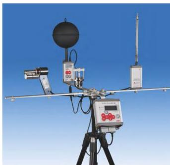
Tutti questi strumenti sono collegati ad una centralina che rileva i dati e fornisce i risultati richiesti, che è possibile scaricare ed elaborare su pc.
