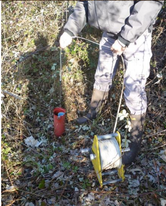
Misurazione del livello della falda
