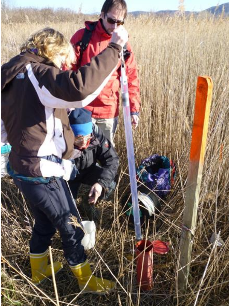
Campionamento a quota delle acque di falda con bailer
