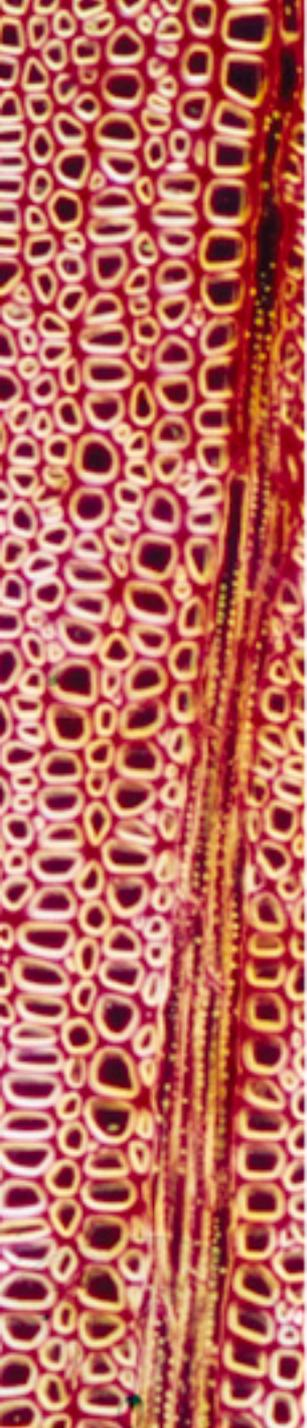
**Durezza del legno:** determinata dalle proporzioni fra i 3 tipi di cellule e grado di ispessimento e lignificazione delle pareti
