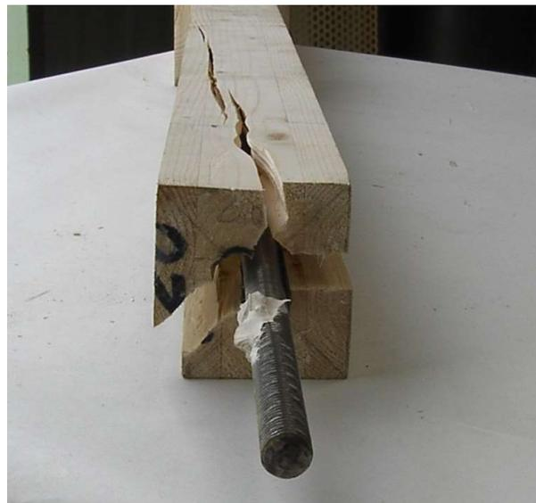
Per evitare la formazione di fessure di spacco nella direzione della barra è necessario rispettare adeguati interassi fra le barre e distanze minime delle stesse dai bordi
