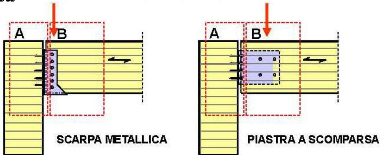
**Nel dimensionamento delle unioni è necessario tener conto delle eccentricità di carico**
