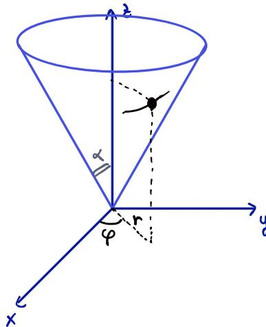
Un punto materiale di massa  $m$  è vincolato a giacere sulla superficie di un cono come in figura. L'asse del cono è verticale e *sul sistema agisce la forza di gravità*.
