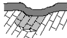
D. di crollo (dislocazione)
