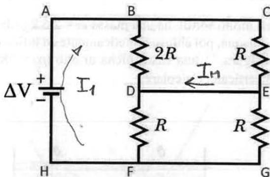
a) La corrente  $I_1$  che percorre il ramo del circuito  $HA$  (ovvero che attraversa il generatore di tensione)
