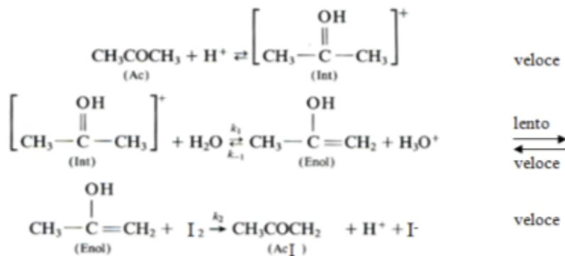
Vengono eseguite cinque cinetiche a diverse concentrazioni di protoni e a concentrazione costante di acetone. La scomparsa dello iodio (reattivo limitante) viene seguita per via spettrofotometrica. Le cinetiche vengono risolte applicando una legge cinetica di ordine zero in iodio:
