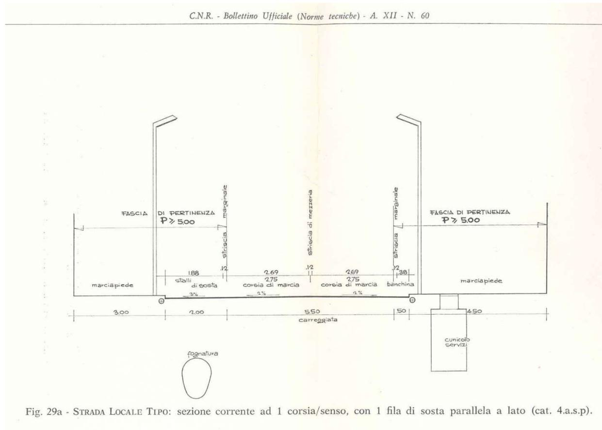
Fig. 29a - STRADA LOCALE TIPO: sezione corrente ad 1 corsia/senso, con 1 fila di sosta parallela a lato (cat. 4.a.s.p).
