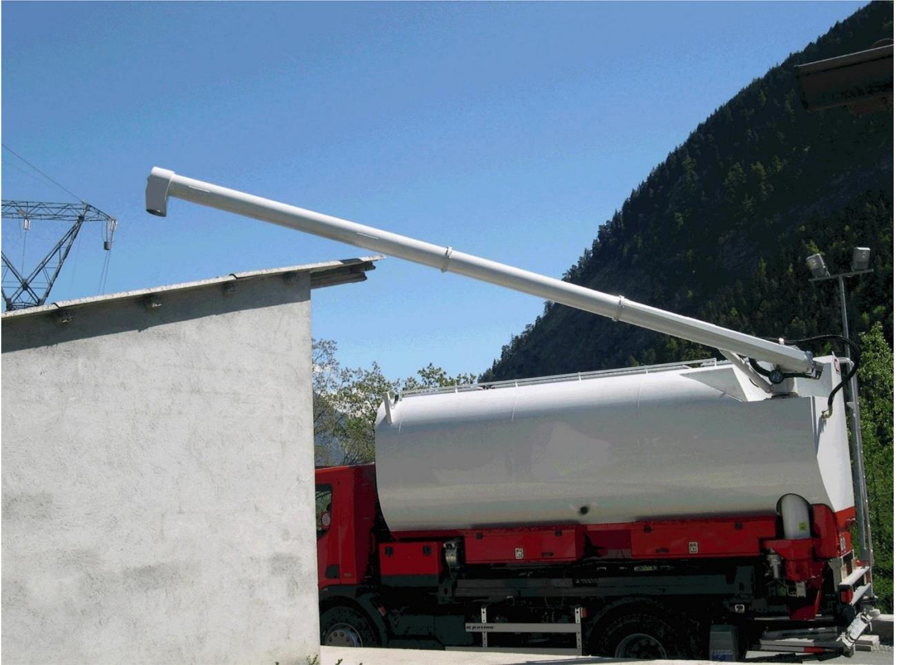
Con riferimento alla cisterna da 8 tonnellate per il trasporto di pellet sfuso di cui alla figura, al candidato è richiesto il dimensionamento di massima dello scaricatore a coclea.
