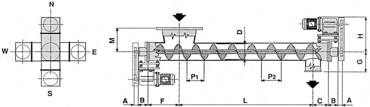
La motorizzazione può essere indifferentemente montata al carico o allo scarico e nelle posizioni indicate ( N - S - W - E).
