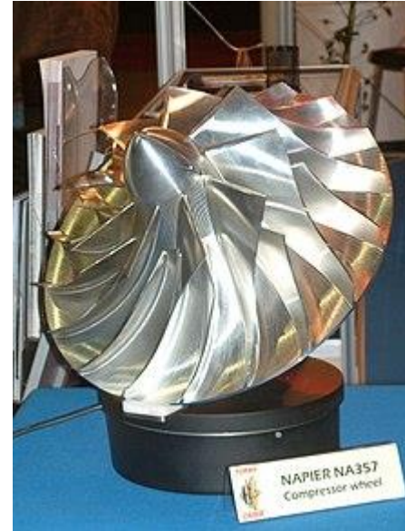
Compressore radiale (macchina termica operatrice dinamica).
