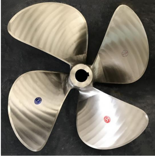
Elica marina (macchina idraulica operatrice dinamica).
