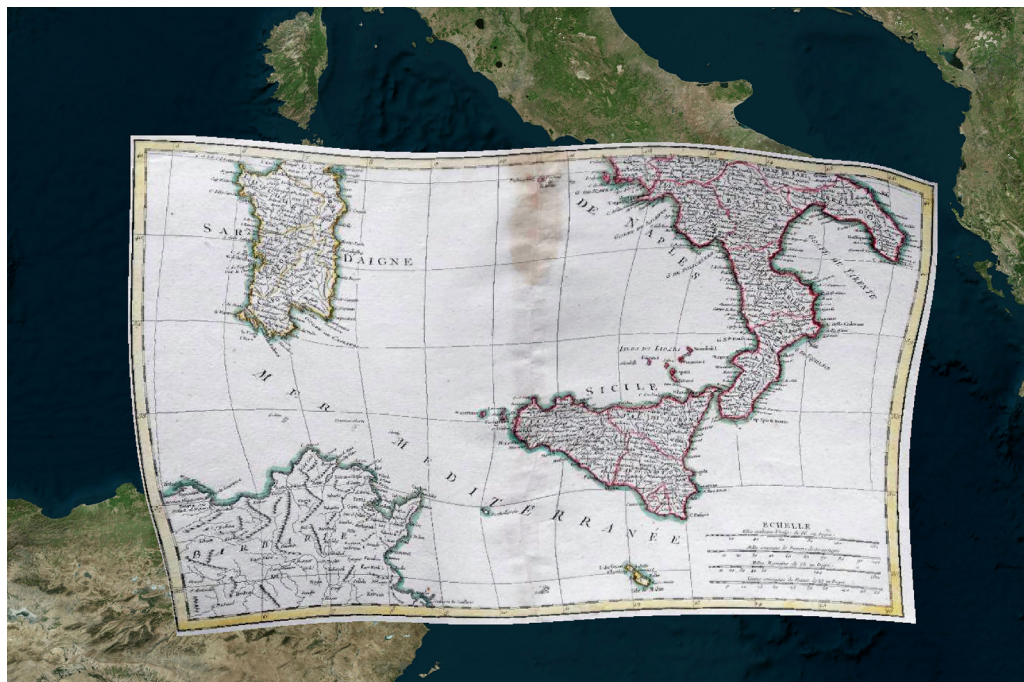
FIGURA 1.2 – Esempio di una carta georeferenziata, deformata nel suo complesso ma non nel dettaglio delle aree terrestri
