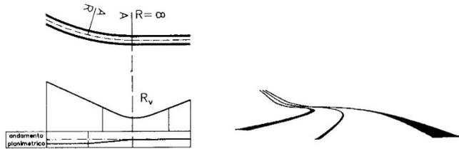
Fig.6 - Falso punto di inflessione ed apparente "strizione" della carreggiata derivanti dalla non corretta posizione relativa delle curve orizzontale e verticale [8]
