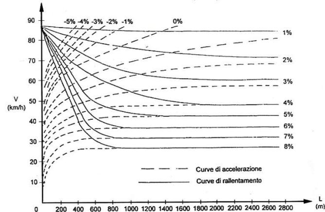
Fig.3c – Variazione della velocità in funzione della pendenza e della lunghezza della livelletta per autocarro pesante ( $W/N=0,83$  pari a 11 CV/t) [4]
