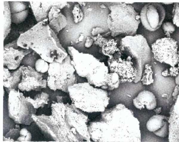
Figura 2 Immagine acquisita con il detector BSE (Back Scattered Electrons) Impostazioni: Magn = 200, HT = 15 kV, Spot = 5
