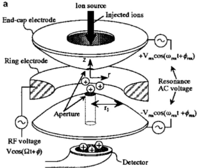
*I due elettrodi iperbolici sopra e sotto fungono da tappi (end caps), l'elettrodo centrale ad anello rappresenta la congiunzione circolare degli altri due elettrodi del quadrupolo lineare.*
