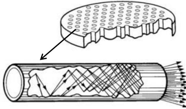
*Questo detector è caratterizzato da una risposta molto veloce poiché il percorso degli elettroni nei canali è molto breve (la lunghezza di ogni microcanale è di pochi millimetri). Quindi è ottimale per essere accoppiato con analizzatori TOF in cui gli ioni arrivano al detector con intervalli temporali di decine o centinaia di ns.*
