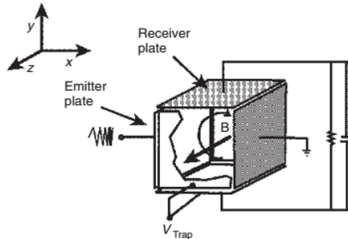
Il campo magnetico è orientato lungo l'asse z. Gli ioni vengono iniettati nella trappola e intrappolati da un voltaggio (1 V) imposto tra i due "plate" opposti della trappola.
