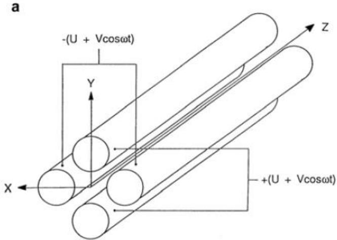
Le barre a due a due opposte sono mantenute allo stesso potenziale che è composto da una componente di **corrente continua (DC)** ed una di **corrente alternata (AC)**
