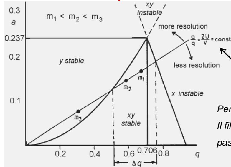
Dettaglio della metà superiore della regione I del diagramma di stabilità per un quadrupolo lineare
