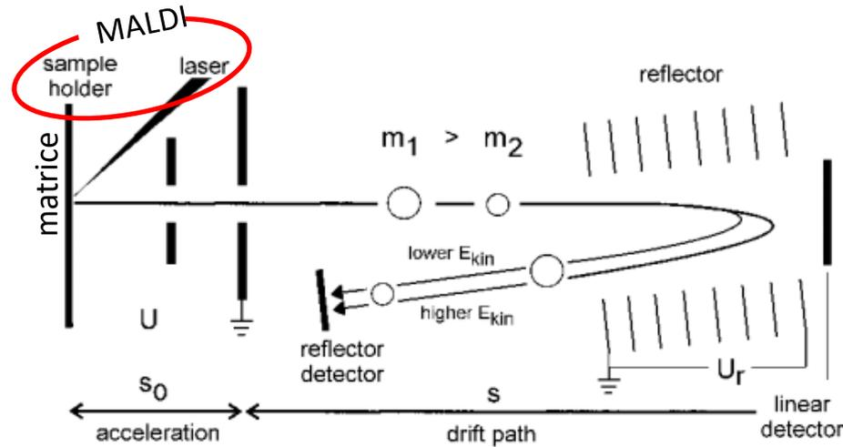
Nel Re-TOF il riflettore è posto alla fine del cammino libero. E' composto da una serie di elettrodi a forma di anello a potenziale via via maggiore quanto più sono posti lontano rispetto alla sorgente di ioni. Il loro voltaggio  $U_r$  è circa 1.05-1.10 volte il voltaggio  $U$  (di accelerazione degli ioni) per assicurare la riflessione di tutti gli ioni in arrivo.
