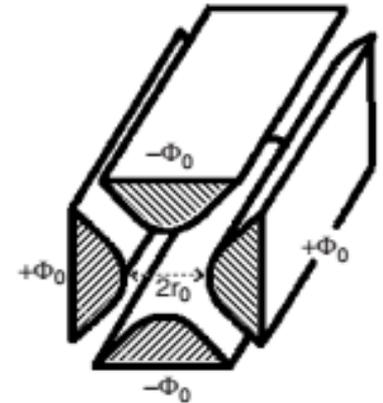
Sezione di un quadrupolo (a) con barre di forma cilindrica, (b) con barre di forma iperbolica. Il campo elettrico è =0 lungo le linee tratteggiate.
