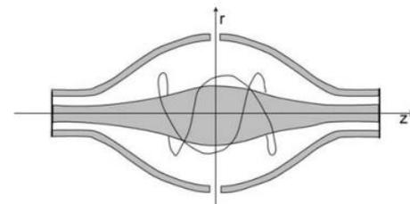
quindi è inversamente proporzionale alla radice quadrata di  $m/z$  ( $k$  è una costante che ingloba le caratteristiche del campo elettrico dovuto alla particolare forma dei due elettrodi concentrici).
