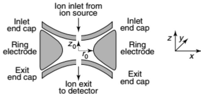
*I due "end caps" sono connessi elettricamente e potenziali DC e RF vengono applicati tra di essi e l'elettrodo circolare.*
