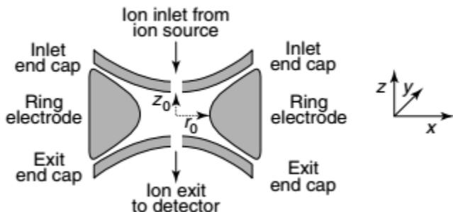
Il QIT intrappola ioni di un determinato intervallo di  $m/z$  (in alcuni tipi di dispositivo gli ioni vengono generati direttamente all'interno della trappola)
