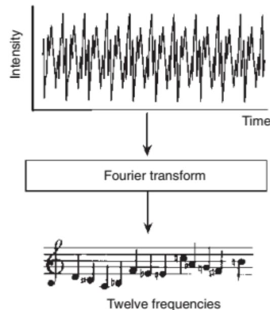
*Nell' analizzatore FT-ICR gli ioni intrappolati nel ciclotrone vengono eccitati simultaneamente da una rapida scansione di un largo intervallo di frequenze (con una corrente alternata AC in radiofrequenza – RF – a voltaggio  $V_0$ ) nel tempo di circa  $1\mu s$ . Gli ioni, eccitati da questa scansione, dispongono la loro traiettoria tutti lungo lo stesso raggio, che dipende da:*
