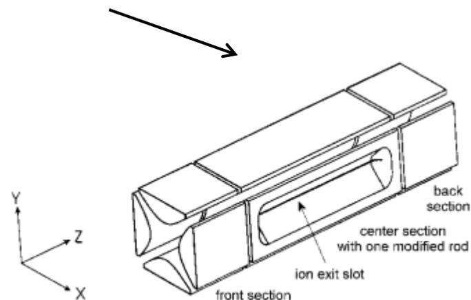
gli ioni vengono espulsi attraverso una fenditura applicando una AC all'elettrodo
