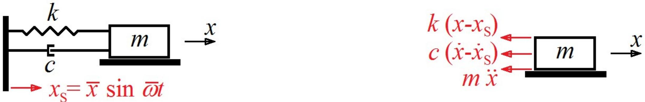
In presenza di un supporto caratterizzato da moto armonico, la risposta di un sistema smorzato ad un grado di libertà è ottenuta risolvendo l'equazione differenziale  $m \ddot{x} + c (\dot{x} - \dot{x}_s) + k (x - x_s) = 0$ .
