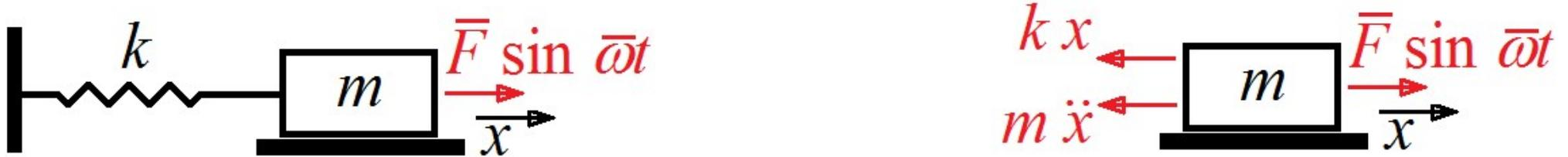
Come si è visto, l'equazione  $m \ddot{x} + kx = \bar{F} \sin(\bar{\omega}t)$  ammette come soluzione l'integrale particolare  $x_p(t) = \bar{x} \sin(\bar{\omega}t)$  con  $\bar{x} = \bar{F} / (k - m \bar{\omega}^2)$ .
