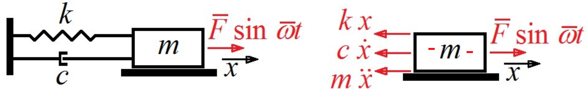
La soluzione dell'equazione differenziale  $m \ddot{x} + c \dot{x} + k x = \bar{F} \sin (\bar{\omega} t)$
