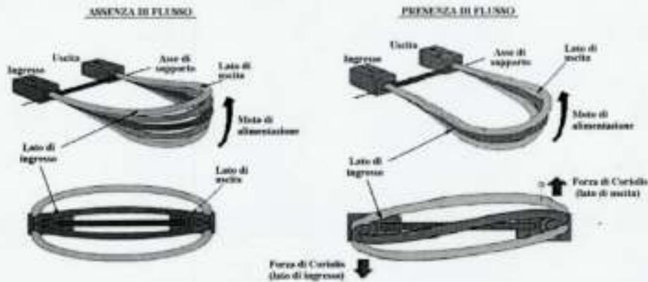
Figura 2.32 – Deformazioni indotte nella tubazione di misura
