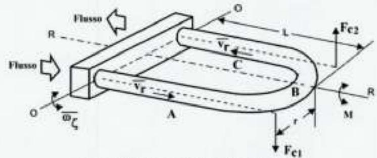
Figura 2.31 - Momento delle forze di Coriolis
