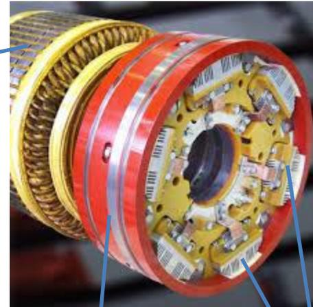
Diodi del raddrizzatore rotante
