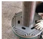
Rotore con barriere di flusso e magneti permanenti
