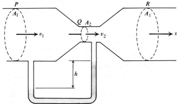
Tubo con strozzatura posto orizzontalmente.
