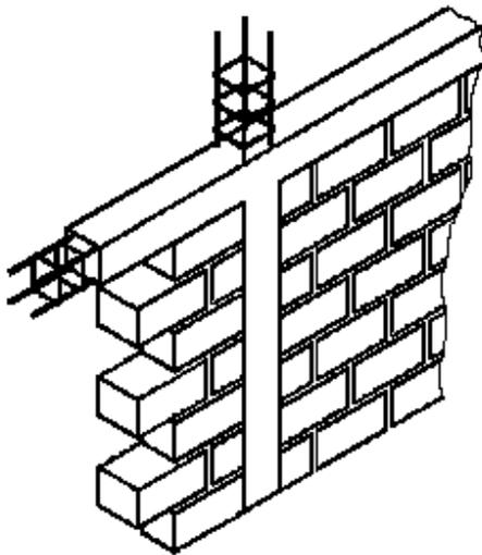
Per garantire un'efficace resistenza alle azioni fuori-piano della parete, la stessa viene eseguita in aderenza alle strutture in c.a.
