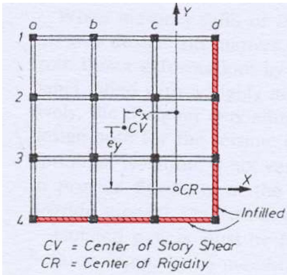
**Esempio 1:** *Struttura intelaiata in c.a. con tamponamenti lungo due lati adiacenti.*
