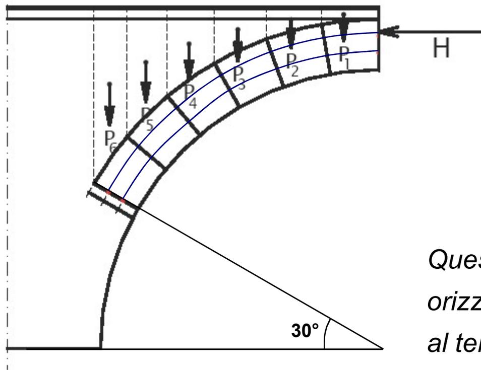
*Si considera solo metà arco, sfruttando la simmetria geometrica e di carico, applicando nella sezione di chiave la reazione dell'altra metà di arco.*
