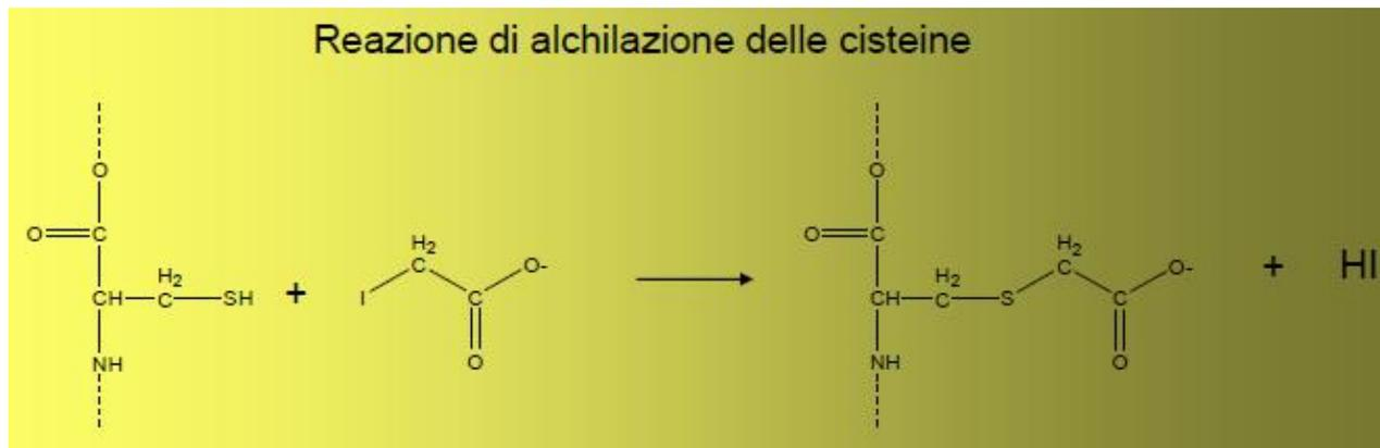
L'S-carbossimetilcisteina a differenza della cisteina e della cistina è resistente alle condizioni di idrolisi e può essere facilmente dosata.
