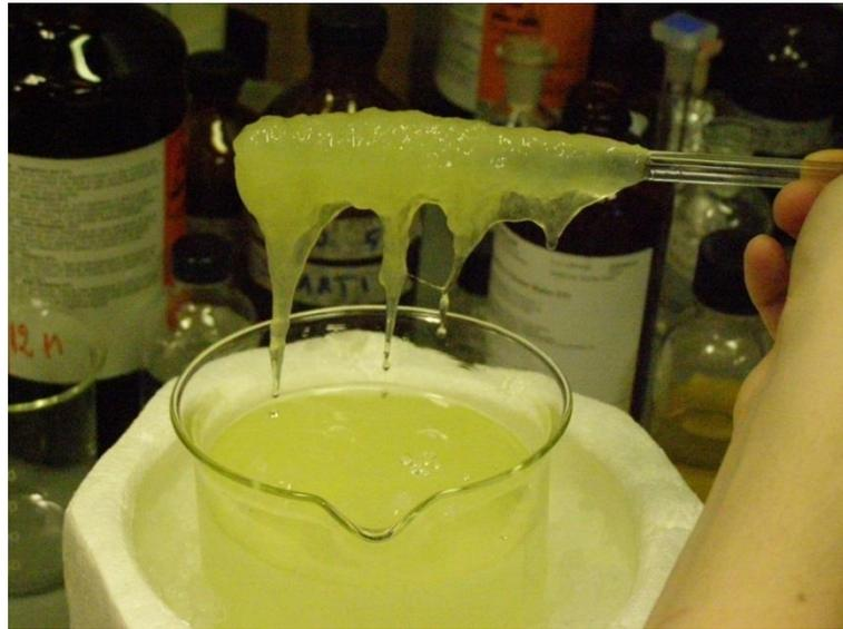
Generalmente la **purificazione** del prodotto si esegue mediante centrifugazione, precipitazione con 4-6 volumi di etanolo (o isopropanolo, o acetone), ri-dissoluzione in acqua e dialisi contro acqua.
