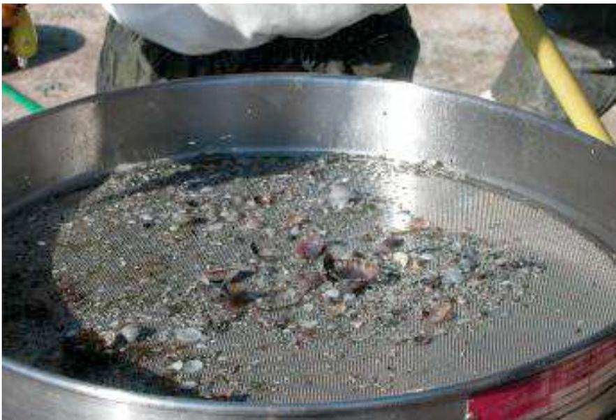
Prelievo di sedimenti mediante bennata e setacciatura dei campioni di sedimento per l'analisi del benthos.
