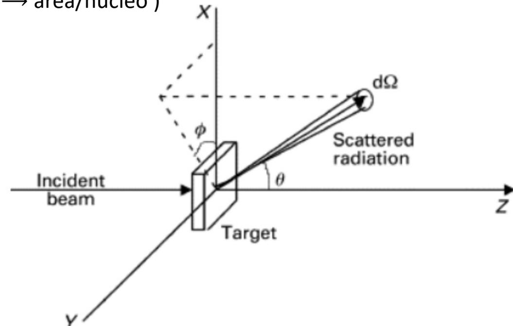
Rivelatore come in fig. che rivela particelle  $b$  entro  $d\Omega = \sin\vartheta d\vartheta d\varphi$
