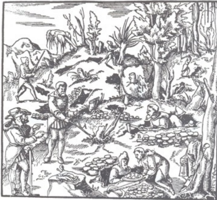
Figura 1.3 Prospezione con una bacchetta a forcilla (A) e con trincee (B) nel quindicesimo secolo. (Da Agricola, De Re Metallica )
