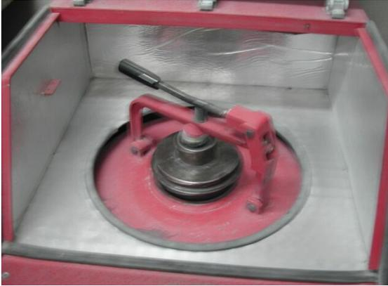
**Figura 47** Mortaio in carburo di tungsteno nella macchina per la frantumazione
