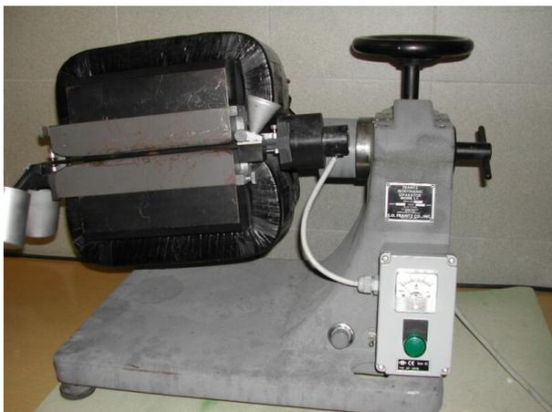
Il campione così trattato viene inserito nel *separatore magnetico (Franz)* che permette di separare i minerali in funzione della loro suscettività magnetica. Il campione, inserito in un contenitore ad imbuto, viene fatto scorrere in due canali che passano all'interno di un campo magnetico creato da una bobina. Per tale ragione, i minerali magnetici scivolano in un canale diverso di quelli non magnetici e vengono raccolti in due
