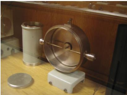
**Figura 28** Strumento per il metodo delle polveri con pellicola
