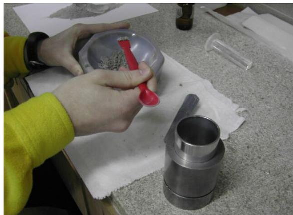
**Figura 50** Inserimento della polvere nel contenitore
