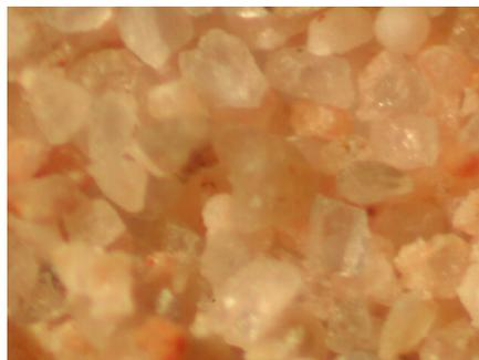
**Figura 45** Minerali non magnetici visti al microscopio
