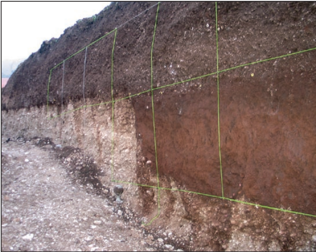
Figura 3.1-5 - Esempio di trincea paleosismologica (T9 della Figura 3.1-4). È evidente la dislocazione dei depositi olocenici.
