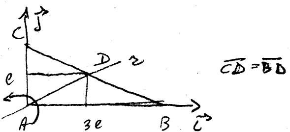
Seguiamo le procedure standard. Determiniamo prima la matrice d'inerzia ss. ad A,  $I_A$  e poi applichiamo le formule
