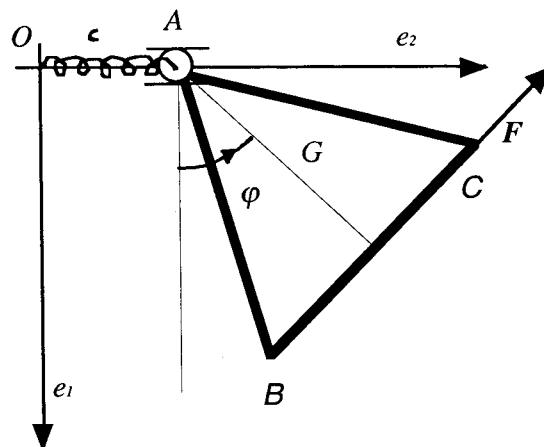
Si vincoli il telaio in un piano verticale con una cerniera liscia in  $A$  e scorrevole su un asse orizzontale. Le forze attive sono: la forza  $\mathbf{F}_C = F_{vers}$  ( $C - B$ ) applicata in  $C$ , la forza di richiamo della molla e il peso proprio del telaio.
