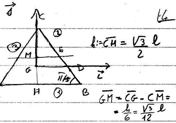
Essendo  $CH$  asse di simmetria materiale ortogonale per il telolo, l'asse  $\vec{j}$  è asse principale d'inerzia per  $G$  e quindi la terna  $(G, \vec{i}, \vec{j}, \vec{k})$  è una terna principale d'inerzia. Dunque, la matrice d'inerzia  $I_G$  è diagonale.
