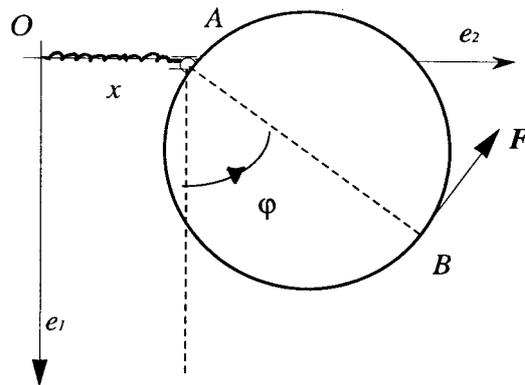
Si vincoli la lamina in un piano verticale con una cerniera liscia in  $A$  e scorrevole su un asse orizzontale. Le forze attive sono: la forza  $F$  applicata in  $B$  e ortogonale al diametro  $AB$ , la forza di richiamo della molla di costante elastica  $3c$  e il peso proprio della lamina.
