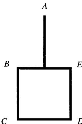
È dato un corpo rigido omogeneo di massa  $m$ , formato da un **telaio** quadrato di lato  $a$  e da un'asta di lunghezza  $a$ , saldata al telaio nel punto medio del lato  $BE$ , come in figura.
