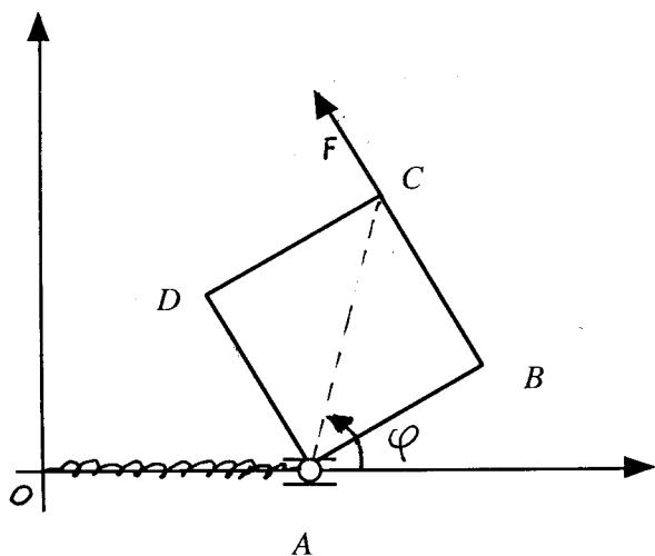
Si vincoli la lamina in un piano verticale con una cerniera liscia in  $A$  e scorrevole su un asse orizzontale. Le forze attive sono: la forza  $\mathbf{F}_C$  applicata in  $C$  e parallela al lato  $BC$ , la forza di richiamo della molla di costante elastica  $c$  e il peso proprio della lamina.
