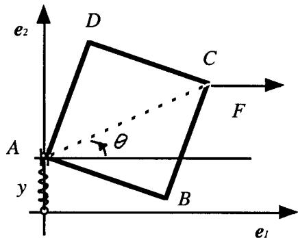
Si vincoli il telaio in un piano verticale con una cerniera liscia in  $A$  e scorrevole su un asse verticale. Le forze attive sono: la forza  $\mathbf{F}_C = F\mathbf{e}_1$  ( $F > 0$ ) applicata in  $C$ , la forza di richiamo della molla di costante elastica  $c$  e il peso proprio del telaio.
