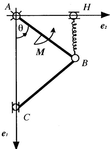
Si consideri il sistema articolato di figura costituito dalle aste omogenee  $AB$  e  $BC$ , di lunghezza  $l$  e massa  $m$ , incernierate in  $B$  e vincolate in  $A$  e in  $C$  su un piano **verticale** (vincoli lisci e bilateri). Il sistema è soggetto al peso proprio delle aste, alla forza elastica della molla (mantenuta verticale dal carrello in  $H$ ) e alla coppia uniforme di momento  $M$  applicata sulla manovella.
