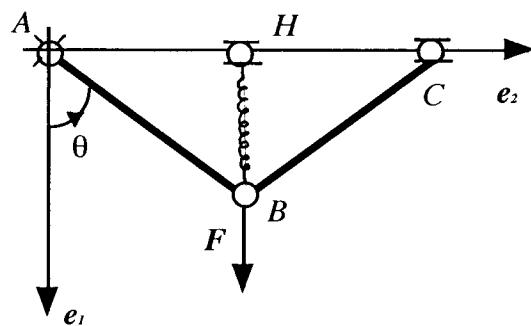
Si consideri il sistema articolato di figura costituito dalle aste omogenee  $AB$  e  $BC$ , di lunghezza  $l$  e massa  $m$ , incernierate in  $B$  e vincolate in  $A$  e in  $C$  su un piano verticale (vincoli lisci e bilateri). Il sistema è soggetto al peso proprio delle aste, alla forza elastica della molla (mantenuta verticale dal carrello in  $H$ ) e alla forza costante  $F$ , applicata in  $B$ .
