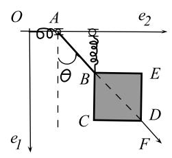
Si vincoli il corpo nel piano <u>verticale</u> con una cerniera liscia nel punto A, scorrevole senza attrito lungo una guida orizzontale fissa. Le forze attive sono: il peso proprio del rigido, la forza di richiamo delle due molle (entrambe di costante elastica c), una collegata in A e al punto fisso O, l'altra collegata in B e sempre parallela al versore  $\mathbf{e}_1$ ; il carico  $\mathbf{F}$  applicato in D e sempre diretto lungo il segmento AD.
