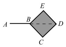
È dato il corpo rigido di figura, formato da un asta omogenea di lunghezza L e massa m, saldata ad una lamina omogenea quadrata di massa 5m e lati  $L/\sqrt{2}$ .
