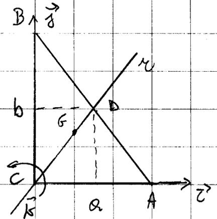
Per il calcolo di  $G$ , ricordiamo che in una lamina omogenea, esso coincide con il baricentro geometrico e quindi divide le mediane (assi di simmetria oblique, congiunti al lato diviso in due dalla mediana) in due parti una doppia dell'altra
