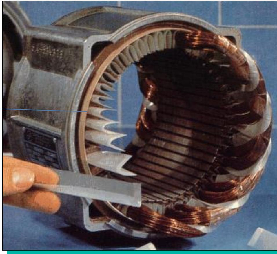
Per macchine piccole in bassa tensione si usano bobine in filo (matasse). La spira può essere formata da un singolo filo o da più fili connessi in parallelo. I fili sono normalmente isolati con smalto (non è previsto isolamento di spira). L'isolamento contro massa e tra lati attivi di matasse entro la stessa cava è formato con carta Nomex inserita nella cava prima di formare l'avvolgimento.
