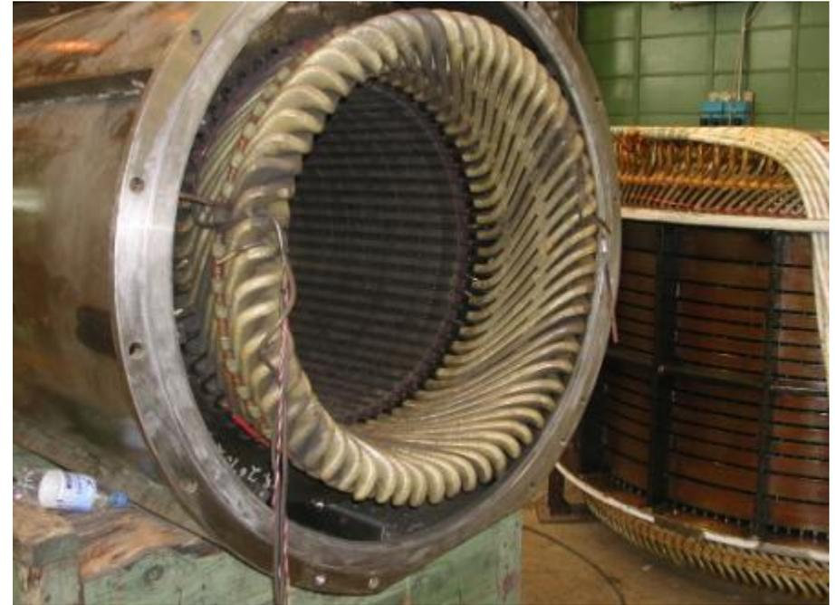
Nel caso di avvolgimento in filo, i conduttori devono essere messi manualmente in cava, formando l'avvolgimento man mano che il conduttore viene avvolto.
