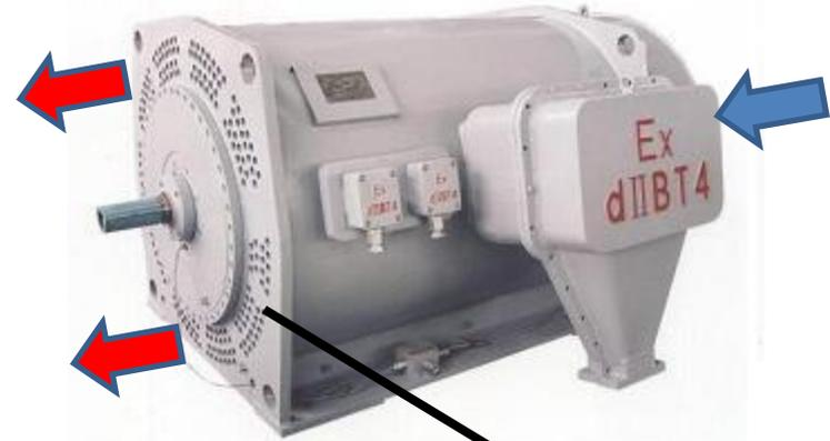
Circuito interno di ventilazione
