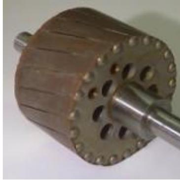
Per pacchi sopra i 250 mm, è necessario che il rotore abbia lo stesso numero e la stessa distribuzione di canali radiali di raffreddamento. Anche per il rotore si usano distanziatori tra pacchetti in corrispondenza dei canali di ventilazione.
