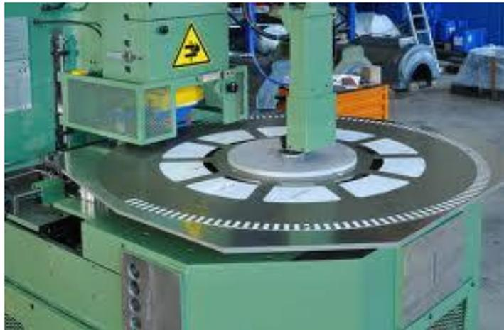
Esempio di macchina punzonatrice e tranciatrice a controllo numerico
