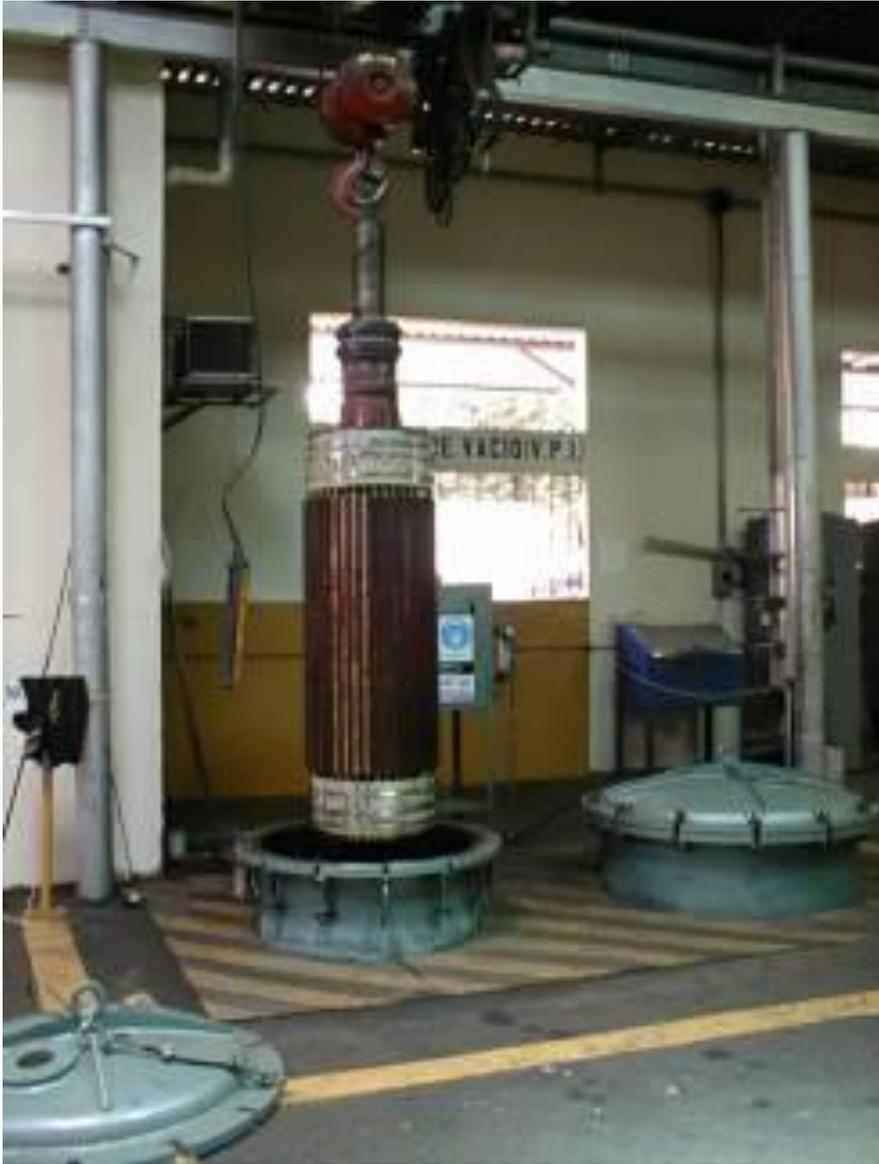
Normalmente anche il rotore, separatamente allo statore, è sottoposto ad impregnazione totale (ad esempio con tecnica VPI).
