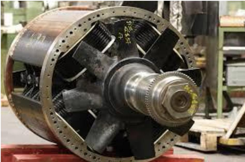
Ventilatore radiale e montato sull'albero
