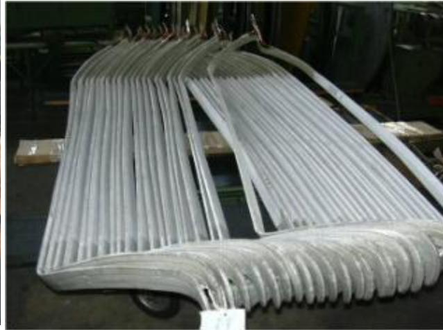
*Bobine formate e nastrate prima del montaggio*
