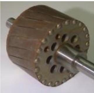
E' fondamentale che l'impaccaggio avvenga allineando esattamente le cave in modo che le pareti di queste non abbiano irregolarità. Si usano allo scopo guide posizionate assialmente sui mandrini. L'uso di guide inclinate consente la realizzazione di pacchi a cave inclinate.
