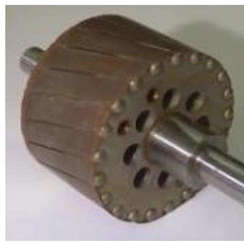
La larghezza dell'intaglio viene stabilita in modo da controllare la induttanza di dispersione della gabbia. Nel caso di cave semichiusure, si verifica una  saturazione del ponticello, che porta, da un punto di vista magnetico, alla creazione di un "intaglio" equivalente.
