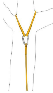
Fig. 5 - Ancoraggio della fune con dispositivo passante
