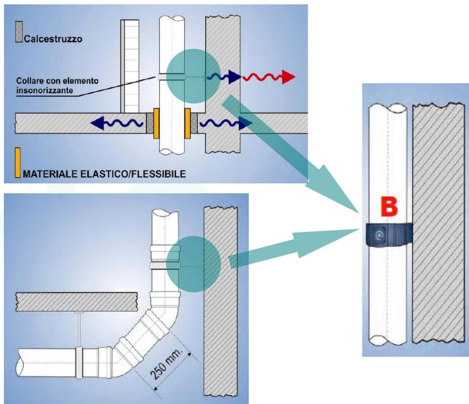
Predisporre alla base delle colonne di scarico due raccordi a 45° tra la giacitura verticale e quella orizzontale (al posto di una curva a gomito), per un tratto lungo almeno 0,25 ml
