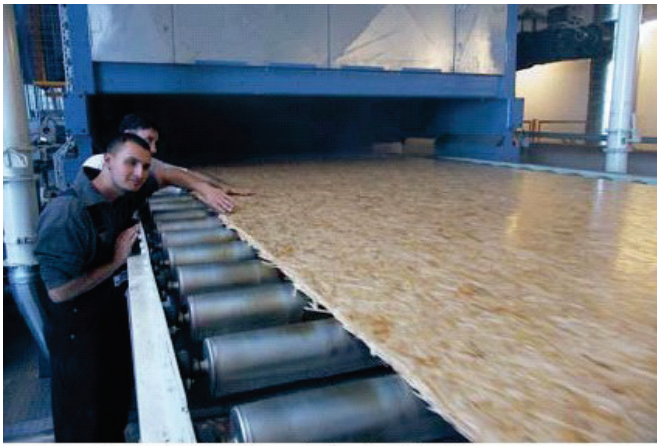
Pannello „ininterrotto“ sui rulli della pressa
