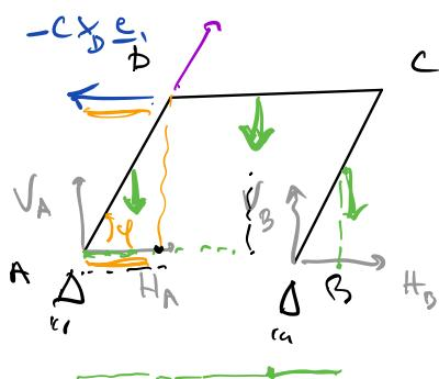
$$\begin{aligned} & l \cancel{V_B} - m_1 g \frac{l}{2} \cos\varphi \\ & - m_2 g \left( l \cos\varphi + \frac{l}{2} \right) \\ & - m_3 g \left( \frac{l}{2} \cos\varphi + l \right) \\ & + c (l \cos\varphi) l \sin\varphi = 0 \end{aligned}$$
