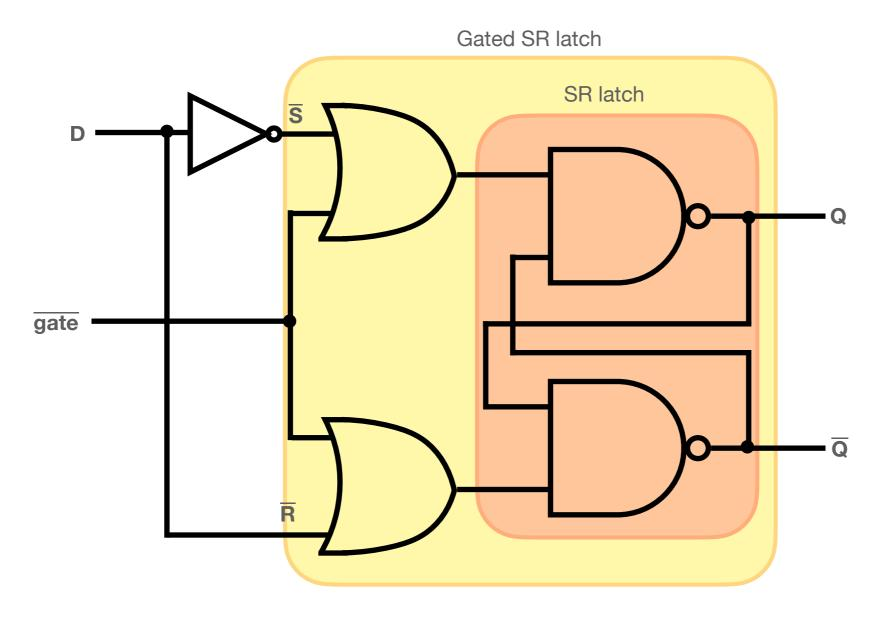
Collegando entrambi gli input in modo che esattamente uno solo sia negato abbiamo che quando gate è a zero viene salvato nel gated D latch il valore attualmente nell'input **D**
