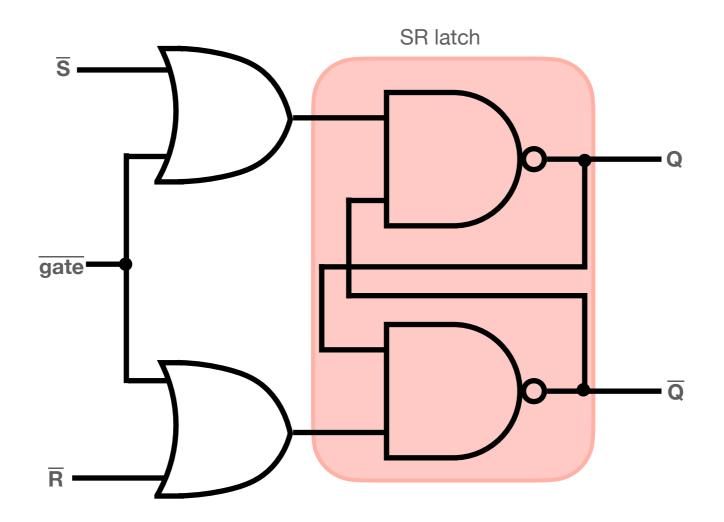
L'aggiunta di due porte OR fa in modo che la modifica del valore salvato sia possibile solo quando gate è a zero
