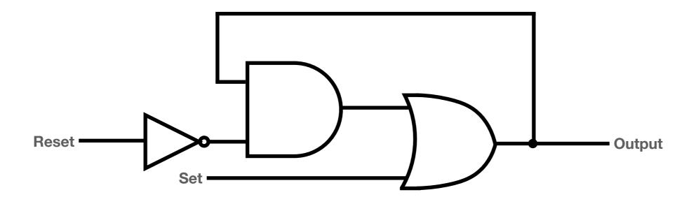
Questo semplice circuito ci permette di immagazzinare un bit di informazione
