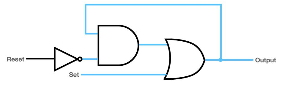
Se **reset** è zero e **set** è uno allora l'output viene impostato a uno
